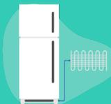
**Installez un récupérateur de chaleur sur les condenseurs.** La chaleur dégagée par les condenseurs lors de la production de froid par les groupes frigorifiques peut être utilisée pour chauffer l'eau par exemple.
